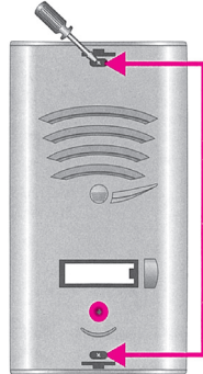
Tornavida yardımıyla vidaları sökünüz
